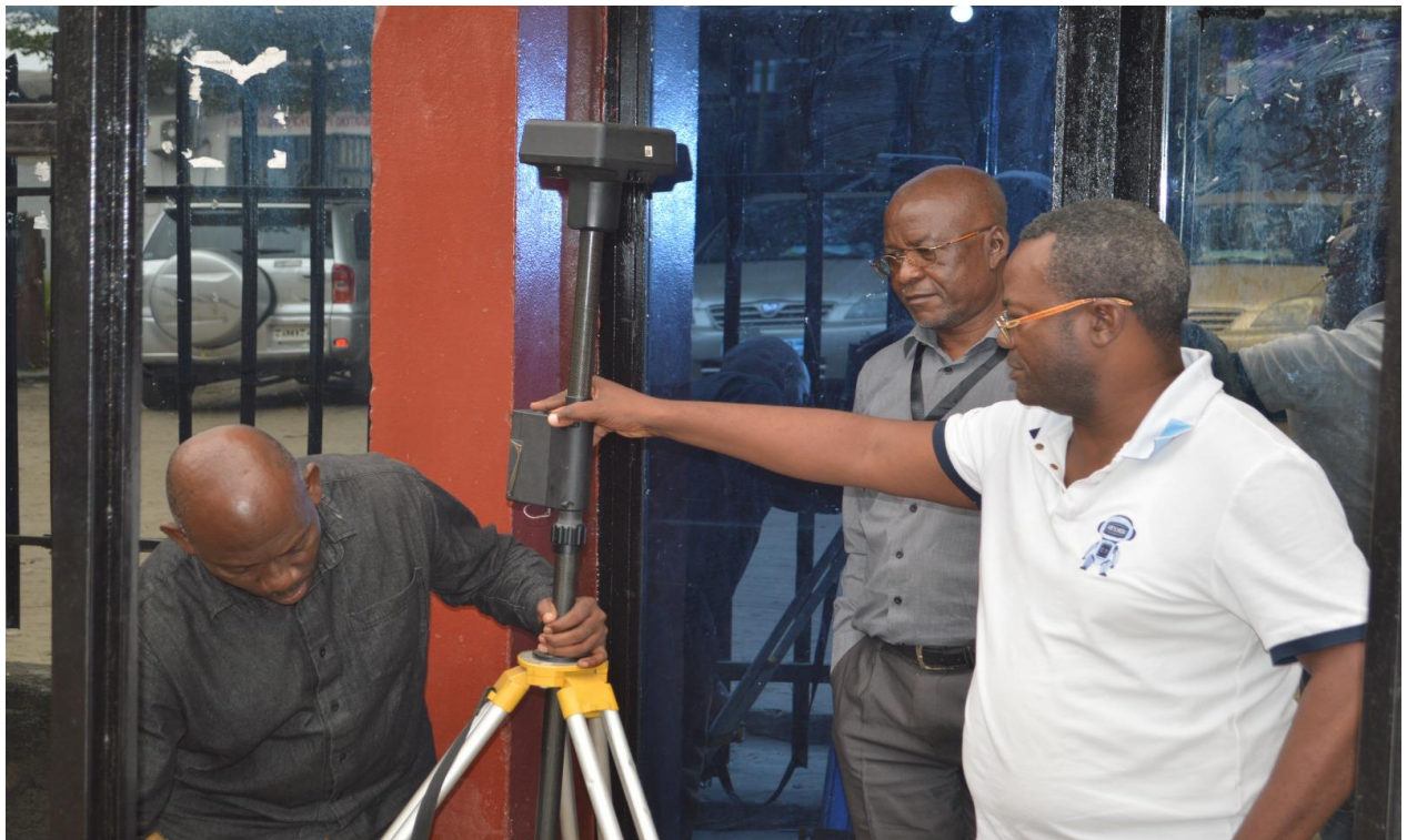
Photo : Montage d'une Antenne Différentielle de Correction des Images de Drones et GPS Différentiel à l'ETS/UPN
